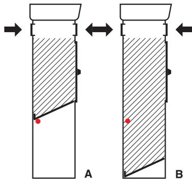
Der Zwischenboden wird mit der nach oben gebogenen Seite so in den Kasten geführt, dass er mit Gefälle nach hinten auf den beiden hinteren Absätzen liegt und vorne an der Innenseite des Kastens lehnt. Wird ein grösseres Volumen gewünscht, versetzt man den Zwischenboden nach unten.
